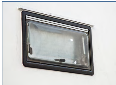
Окна со встроенной солнцезащитной шторкой и противомоскитной сеткой.
