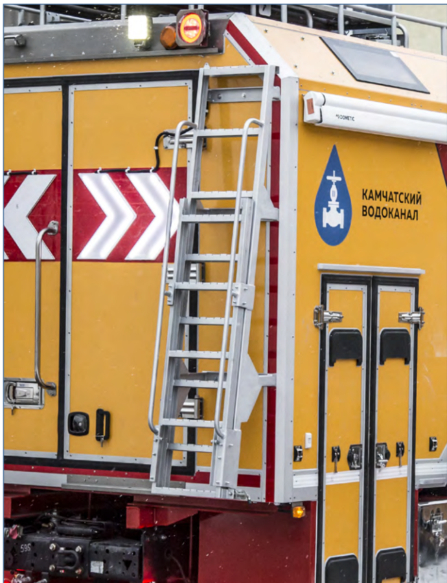
Лестница на крышу.
