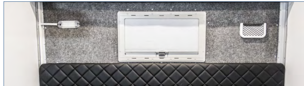
Отделка ковровином стен над спальными
