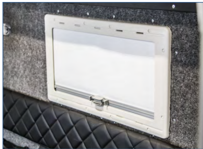
Окна со встроенной солнцезащитной шторкой и противомоскитной сеткой.
