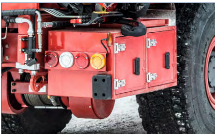
2 сварочных поста – 2 катушки.
