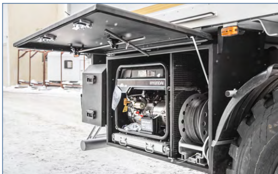
Электрогенератор на выкатной платформе в ящике под фургоном.
