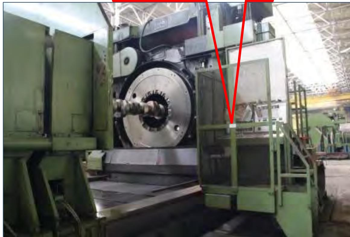
Вихрефрезерный станок, инв.№ 8585.
