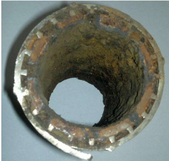
Разрез каркасного фильтра, извлеченного из скважины ПХГ
